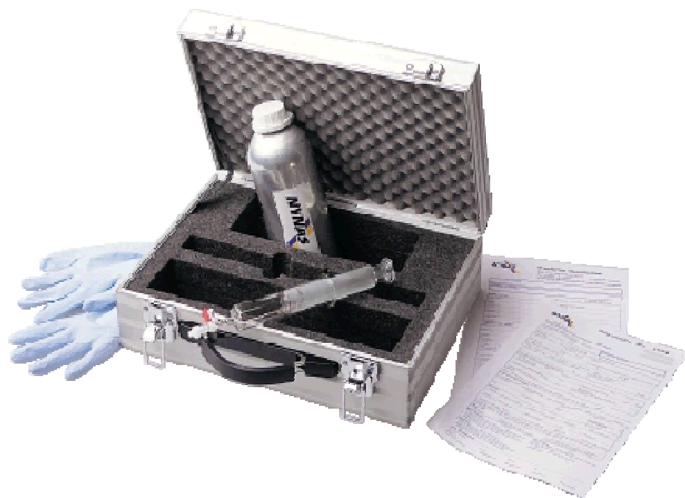
Rys.3. Zestaw Nynas do poboru próbek oleju transformatorowego
